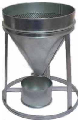
Նկ.4. Փխրուն վիճակում խտության որոշման փորձասարք
